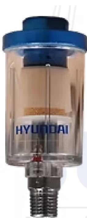
El separador de aire y agua Hyundai HYAC215 es un filtro diseñado para instalarse en la entrada de aire de pistolas o herramientas neumáticas. Su función principal es eliminar partículas grandes de agua y aceite antes de que el aire alcance el material a pulverizar, garantizando aplicaciones más limpias y eficientes. Además, cuenta con un pivote de drenaje que facilita la extracción del agua acumulada en el depósito del separador.
